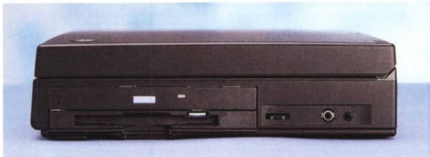
Le due fiancattine del ThinkPad ricche di dotazioni: in alto notiamo i due slot PCMCIA e il sensore IrDA, in basso i due drive (floppy e CD) e le connessioni audio.
